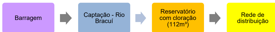
FIGURA 5-33 – FLUXOGRAMA DO SISTEMA DE ABASTECIMENTO DE ÁGUA BRACUÍ – SUBSISTEMA SANTA RITA DO BRACUÍ Fonte: SAAE, 2021.
