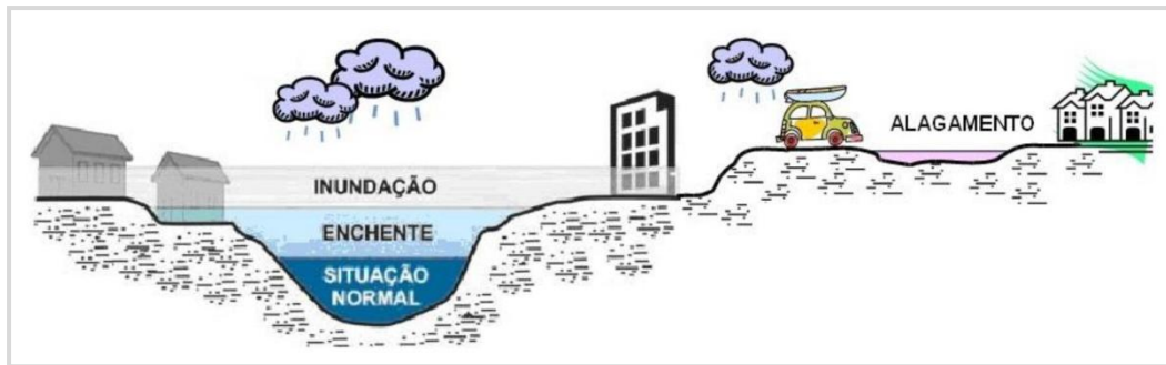
Figura – Enchente, inundação e alagamento. Fonte: Defesa Civil
