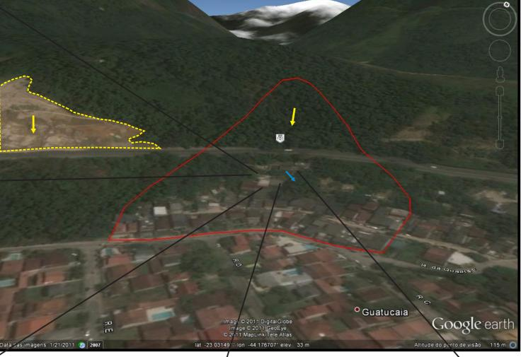
**Descrição:** Encosta íngreme com risco de escorregamento planar por deficiência de drenagem proveniente da encosta e da BR101. Possibilidade de rolamento de blocos e pequenas corridas de lama e detritos. Em área adjacente ocorreu escorregamento planar de grande porte ocorrido em 2010 e está sendo contemplado com obra de contenção.
