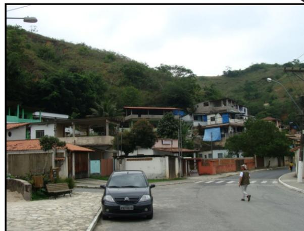
**Descrição:** Ocupação em base de encosta com risco remanescente de escorregamento planar solo/solo. Feições de rastejo instalado.
