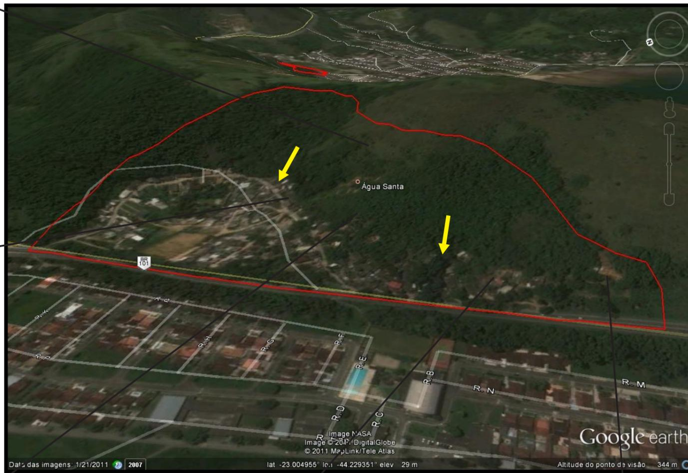
**Descrição:** Encosta montanhosa com ocupação na base com grande volume de blocos e matacões sujeitos a rolamento. Risco remanescente de escorregamento planar solo/solo. Presença de casas parcialmente destruídas.
