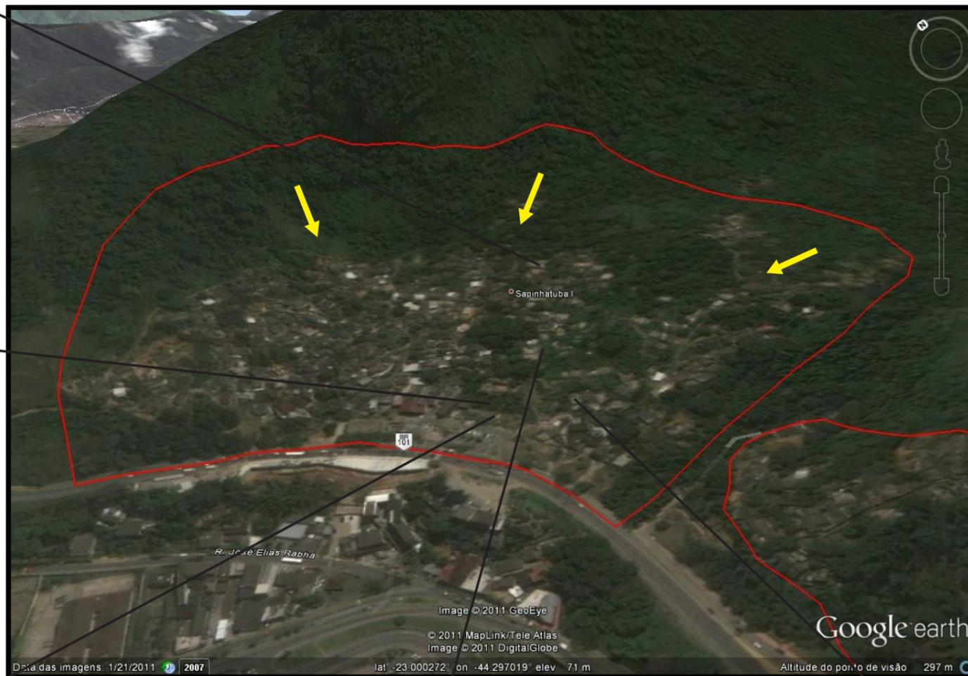
**Descrição:** Encosta montanhosa formada por depósito de talus densamente habitada, com ocupação desordenada, com rastejo instalado, com alta taxa de movimentação. Diversas casas demolidas e interditadas. Risco de dano em estruturas em razão do rastejo, escorregamento planar e rolamento de blocos.
