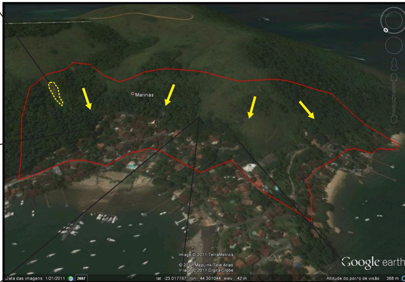
**Descrição:** Encosta montanhosa com depósito de talus e grande volume de blocos e matacões instáveis. Feições de movimentação de matacões com diâmetros superiores a 10m. Risco remanescente de escorregamento planar ocorrido em 2010.
