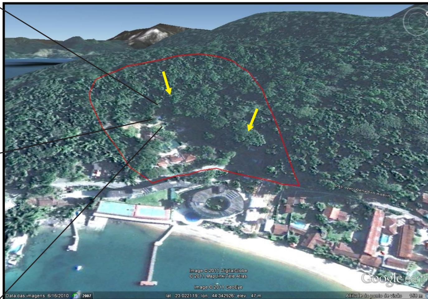
**Descrição:** Encosta íngreme com talvegue de drenagem intermitente com presença de grande volume de blocos e matacões. Risco de escorregamento planar solo/solo e rolamento de blocos.
